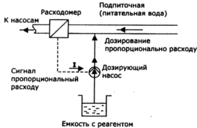
Рис. 1. Типовая схема дозирования
